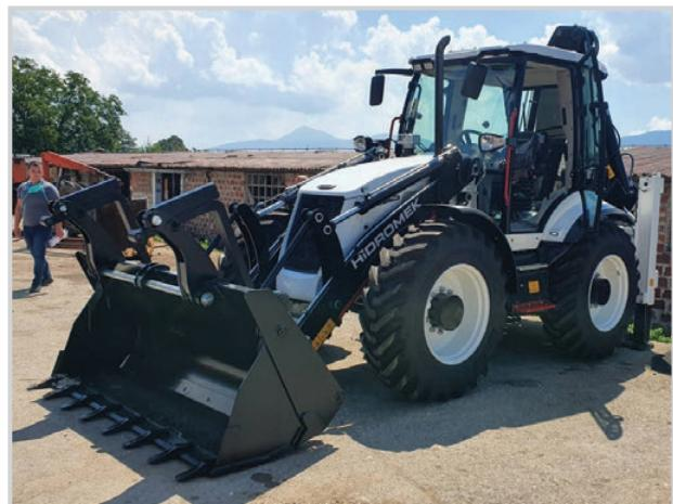
Slika 7. Utovarivač-rovokopač Hidromek tip 102S
