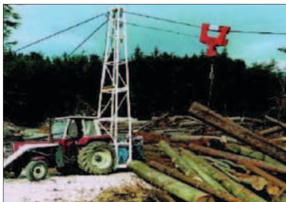
Slika 3. Razne varijante pogona žičare za kraće udaljenosti (do 300 m) Figure 3. Different types of forest skylines driving for short distances (up to 300 m)
