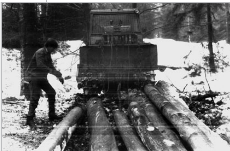
Slika 6. Radilište Luke, odjel 124 - vuča bukovih trupaca traktorima
