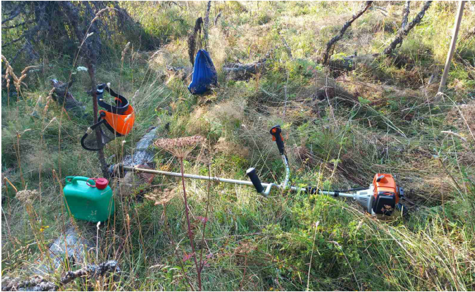
Slika 14. Uklanjanje korovske vegetacije motornim trimerom. Uz trimer se uvijek nosi zaštitna oprema kao i gorivo i pribor (Foto: Mešković, E.)
