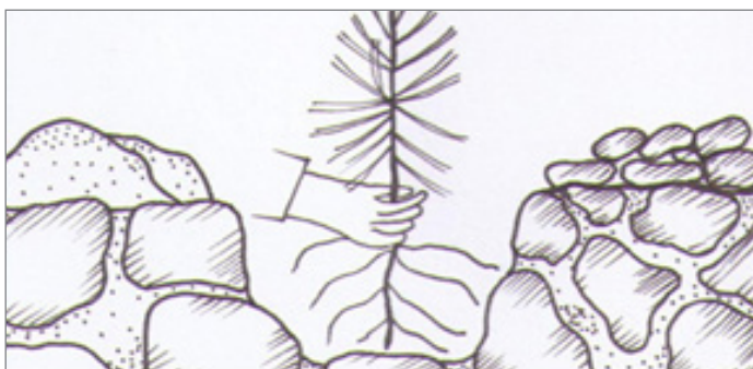
Skica 9. Postavljanje sadnice u sadnu jamu i postupak sadnje
