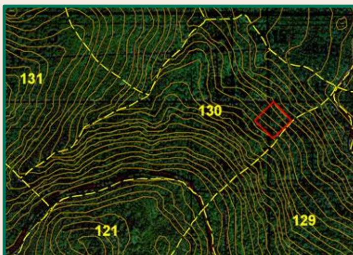
Slika 17. Satelitski snimak užeg područja ogledne plohe 130 s izohipsama, granicama šumskog odjeljenja 130 i granicama stalne ogledne plohe
